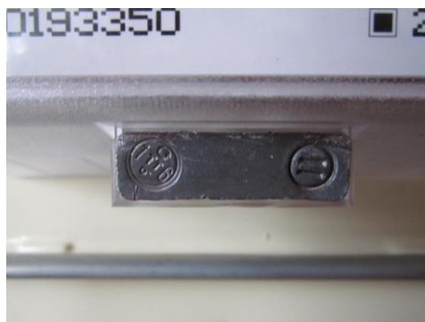
Рис. 3 - Место пломбирования сумматора счетчика
